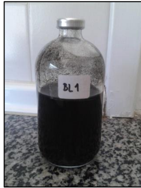
Figura 4.7. Botella-reactor Wheaton, una vez llenada y cerrada.
