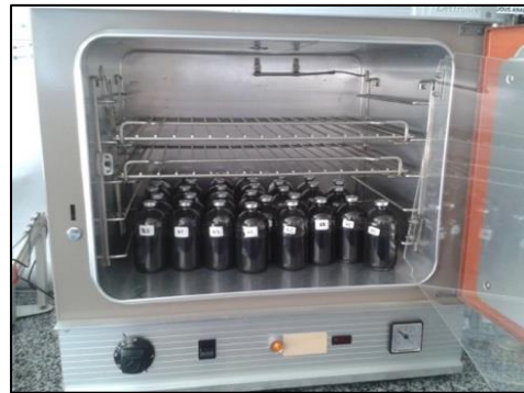
Figura 4.9. Incubadora donde se realiza la digestión anaerobia con las botellas en su interior.
