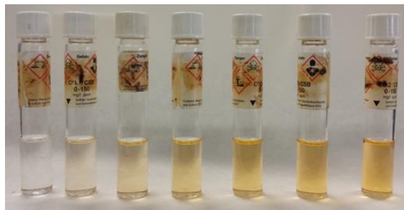
Figura 4.20. Blanco y soluciones de glucosa para realizar la curva estándar preparada.
