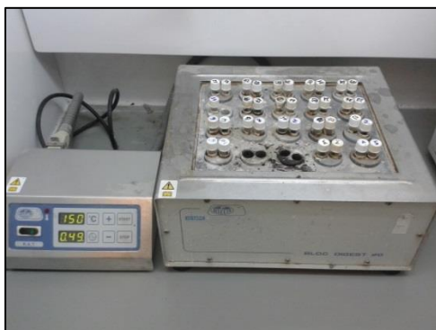
Figura 4.15. Placa digestora con los tubos de DQO.
