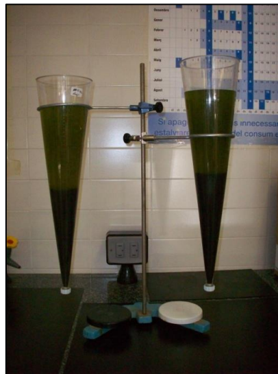
Figura 4.6. Conos de decantación para la sedimentación de la biomasa algal.
