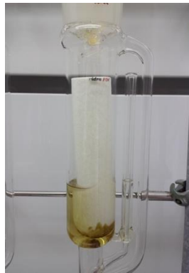
Figura 4.18. Cartucho de celulosa y solvente impregnado con el sólido.
