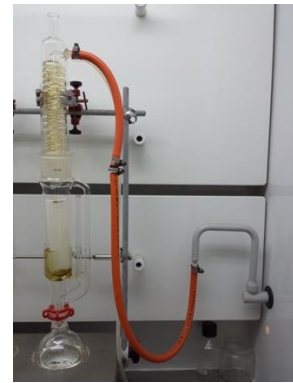
Figura 4.19. Instalación del equipo Soxhlet.
